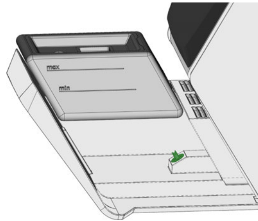
FIG. 37 – LE COUPLAGE DU RÉSERVOIR ET DE SA CONTREPARTIE (DE COULEUR VERTE)
