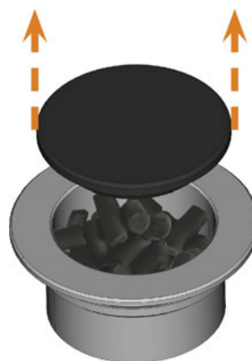
FIG. 83 – ABRIR EL FILTRO DE CARBÓN
