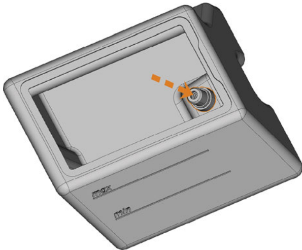
FIG. 90 – EMPUJAR EL ENGANCHE FUERA DEL DEPÓSITO
