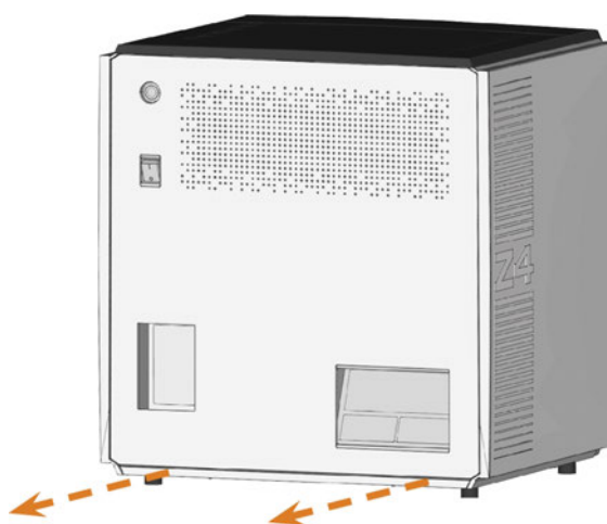
ABB. 60 – DIE RÜCKWANDABDECKUNG ENTFERNEN
