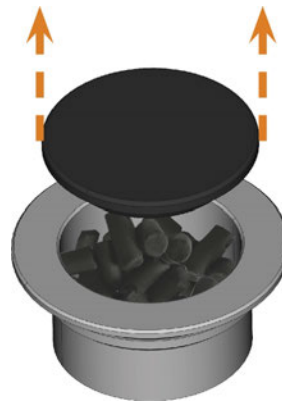
ABB. 83 – DEN AKTIVKOHLEFILTER ÖFFNEN
