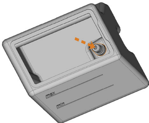
FIG. 90 – EXTRAIRE LE COUPLAGE HORS DU RÉSERVOIR
