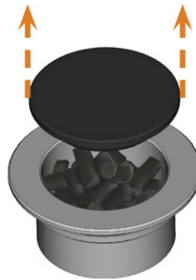
FIG. 83 – APERTURA DEL FILTRO AL CARBONE
