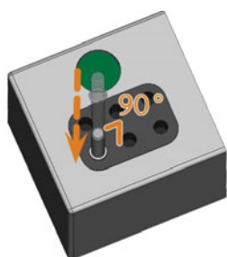
FIG. 43 – INSÉRER DES OUTILS DANS LES POSITIONS DES OUTILS
