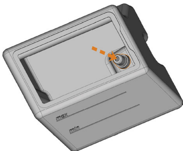
Abb. 90 – KUPPLUNG AUS DEM BEHÄLTER DRÜCKEN
