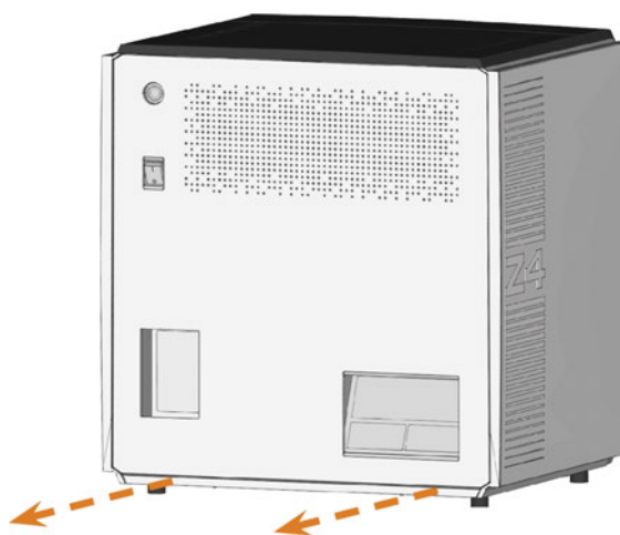
FIG. 60 – RIMOZIONE DEL COPERCHIO DEL PANNELLO POSTERIORE
