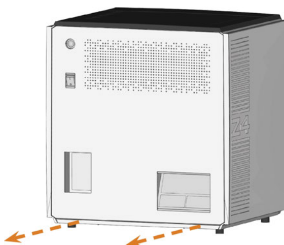
FIG. 60 – RETIRER LE COUVERCLE DU PANNEAU ARRIÈRE
